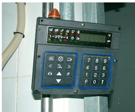
Dispositivo que permite la regulación y control los parámetros de ordeño (retirada de pezoneras, tiempo de ordeño, pulsación etc.)
