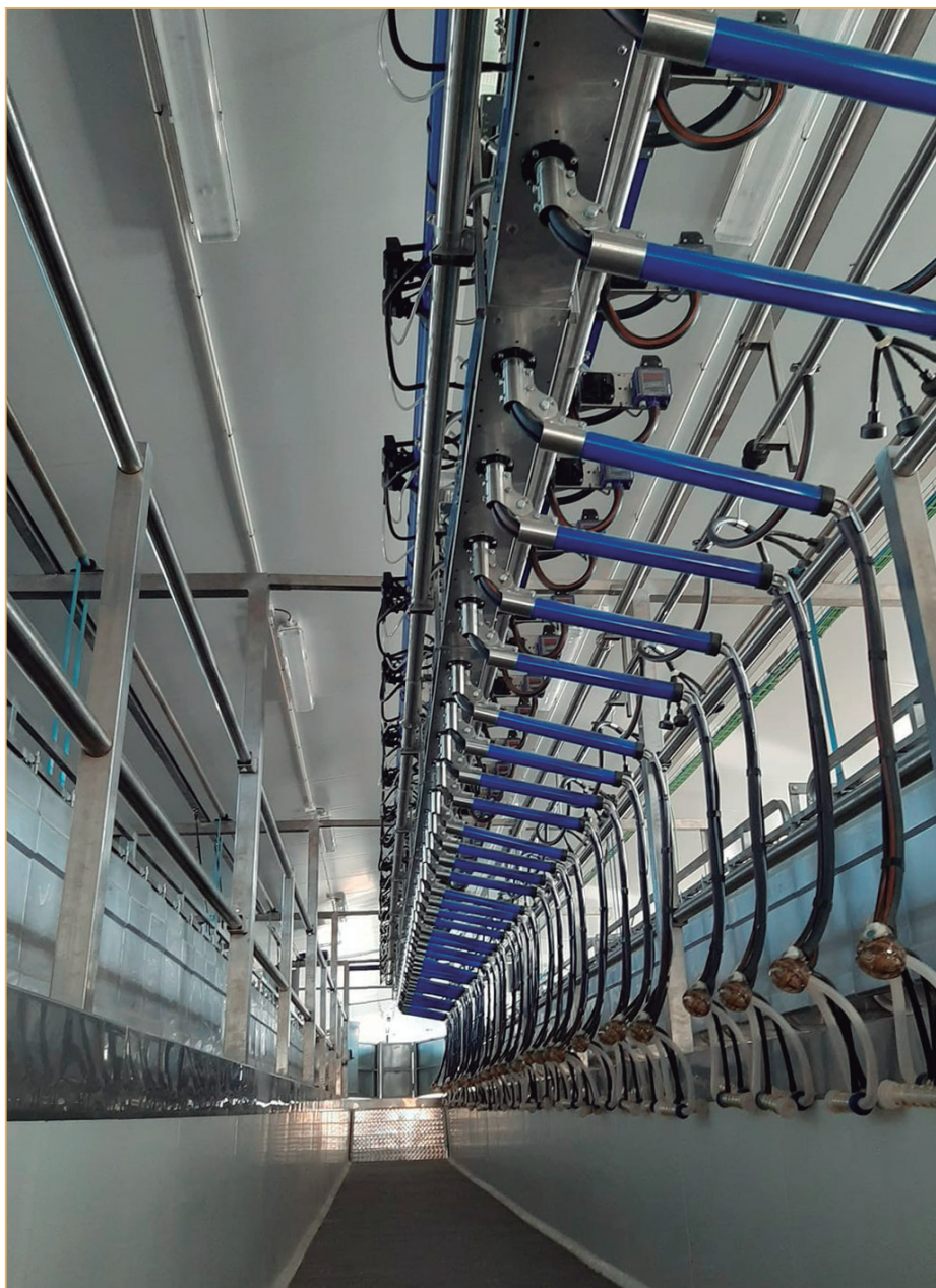
Sala DeLaval SG300 2x40x40 Midiline con medición electrónica e identificación.
