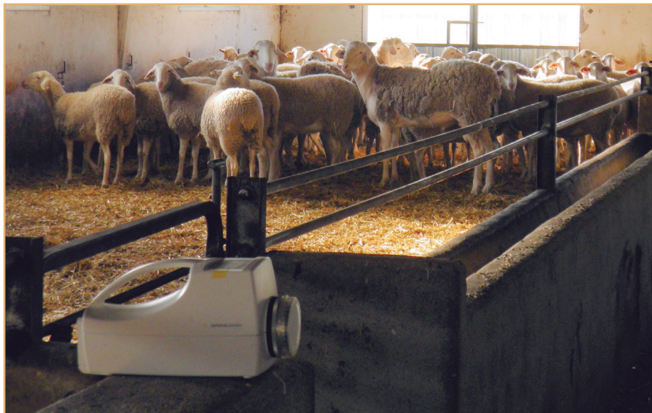
Foto 1. Captador de aire en la nave del ganado.
